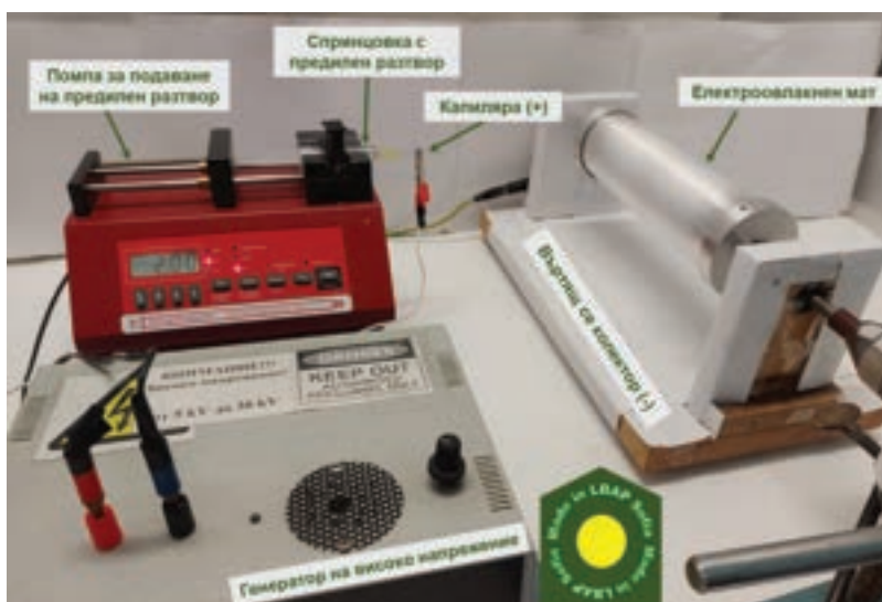
Апаратурата за получаване на нановлакнести материали чрез електроовлажняване бе разработена в началото на века в България
