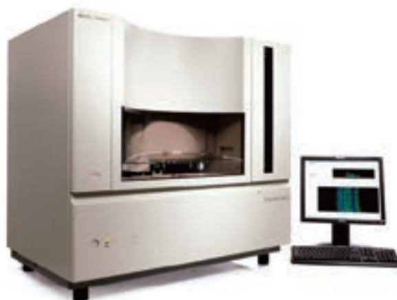
Капилярен ДНК-секвенатор ABI Prism 3730, работещ с 48 капиляра
