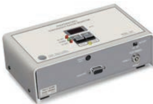
Специален уред, поставен в най-долното помещение на сградата, отчита количеството радон във въздуха
