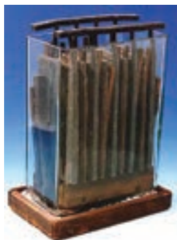
Оловният акумулатор, създаден през 1859 г. от Гастон Планте
