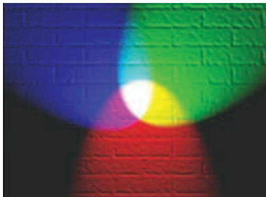
Излъчвателни диоди в трите основни цвята син, зелен и червен, и получаване на бяла светлина чрез комбинацията им
