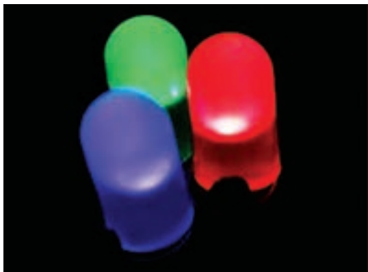
Излъчвателни диоди в трите основни цвята син, зелен и червен, и получаване на бяла светлина чрез комбинацията им
