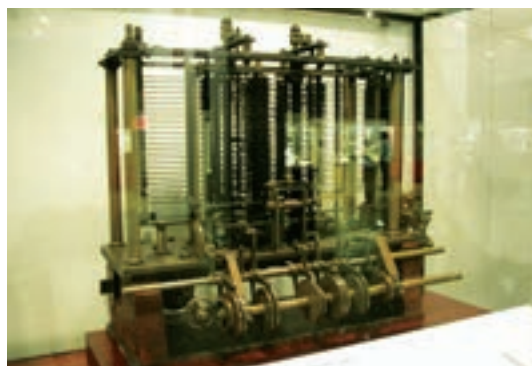
Експериментален непълен модел на аналитичната машина, създадена от Чарлз Бабидж, Музей на науката, Лондон
