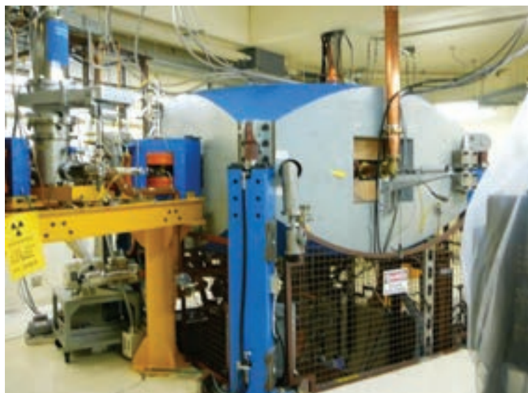
Циклотрон TR-30 за производство на медицински радионуклиди на фирмата Advanced Cycloytron Systems Inc. (ACSI)
