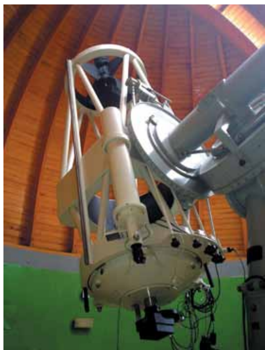
60 см Касегрен телескоп в НАО. Неговата зрителна тръба е конструкция тип Серюре (Serrurier). Съставена е от централен пояс, към който чрез тръбна конструкция са прикрепени заден и преден пръстен, носещи съответно главното и вторичното огледало
