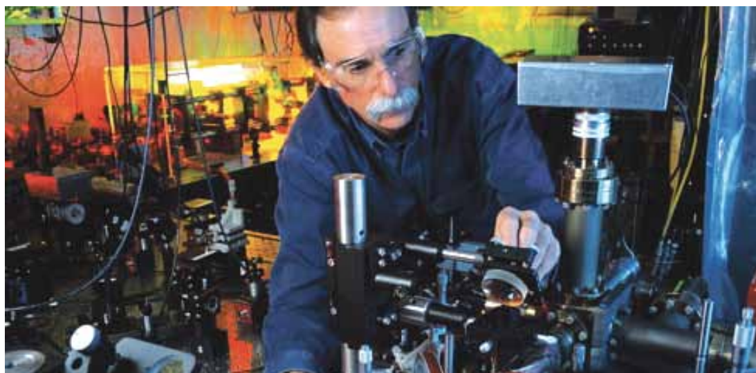
Дейвид Уайнленд в неговата лаборатория настройва ултравиолетов лазерен лъч, който се използва за управление на апарат с висок вакуум, съдържащ йонна уловка. Тези уреди се използват за демонстриране на основните операции, необходими за действието на един квантов компютър
