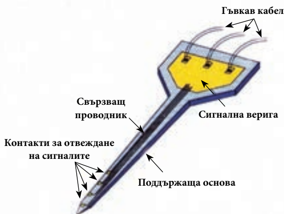
Електроди за извършване на енцефалографски записи
