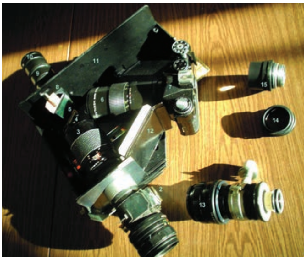
Саморъчно конструиран от автора спектрограф с отразяваща дифракционна решетка (1996 г.)
