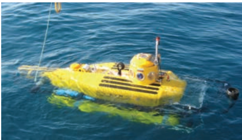
Изследователската миниподводница РС-8В е в експлоатация от 1987 г. Тя е с дължина 6,5 м, тегло 5 тона и работна дълбочина до 250 м. Научното оборудване на РС-8В включва фотокамера, видеокамера, манипулатор и пробовземачи устройства
