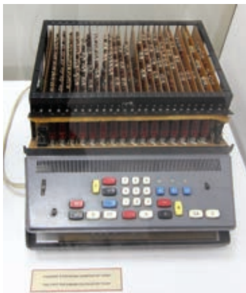
„Елка-6521“ - първият български електронен калкулатор. Тежи 8,5 килограма, има 3 регистра и работи с 12 десетични числа. Създаден е през 1965 г. в Института по математика към БАН от Стефан Ангелов, Любомир Антонов и Петър Попов
