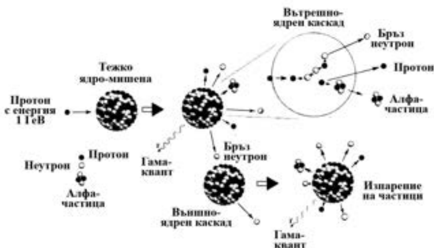
Схема на взаимодействията в процеса на дълбоко ядрено разцепване (spallation), при облъчване на ядро-мишена от тежък елемент с високоенергетични неутрони
