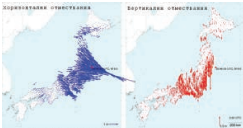
Хоризонтални и вертикални отмествания, регистрирани по време на земетресението в Япония на 11 март 2011 г.
