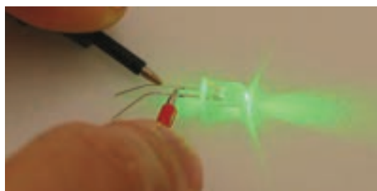
Най-разпространеният тип светодиоди: 5 мм цилиндричен пластмасов прозрачен корпус
