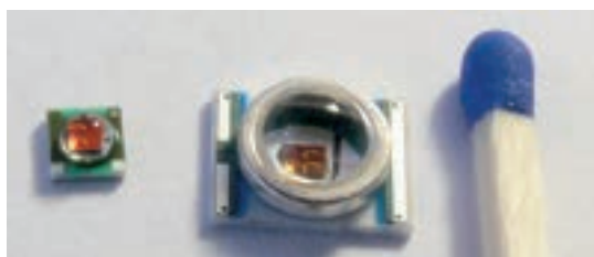
Мощни светодиоди за осветление. Отляво – кехлибар 1,15W, отясно – червен 2W
