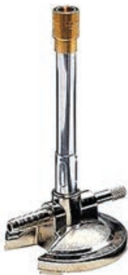
Бунзеновата горелка. От ляво се поставя марку- чът, по който в горелката постъпва горливият газ, а от дясно се регулира достъпът на въздух, т.е. на кислород
