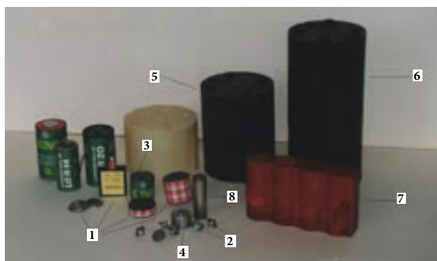
1 – елементи литий-манганов диоксид; 2 – извод метал-стъкло-метал; 3 – елемент \phi 24h35 ; 4 – елемент \phi 20h20 ; 5 – литиева батерия за изделието „Стършел“; 6 – СКА 1500; 7 – литиева батерия за изделие „Тинтява“
