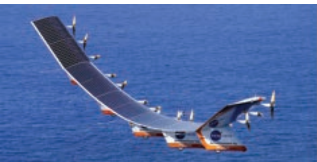
Електрически самолет Хелиос (вляво) и електрически самолет Кинетик Зефир (вдясно)
