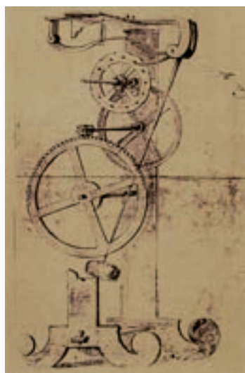
Схемата на Галилео Галилей за часовников механизъм с махало
