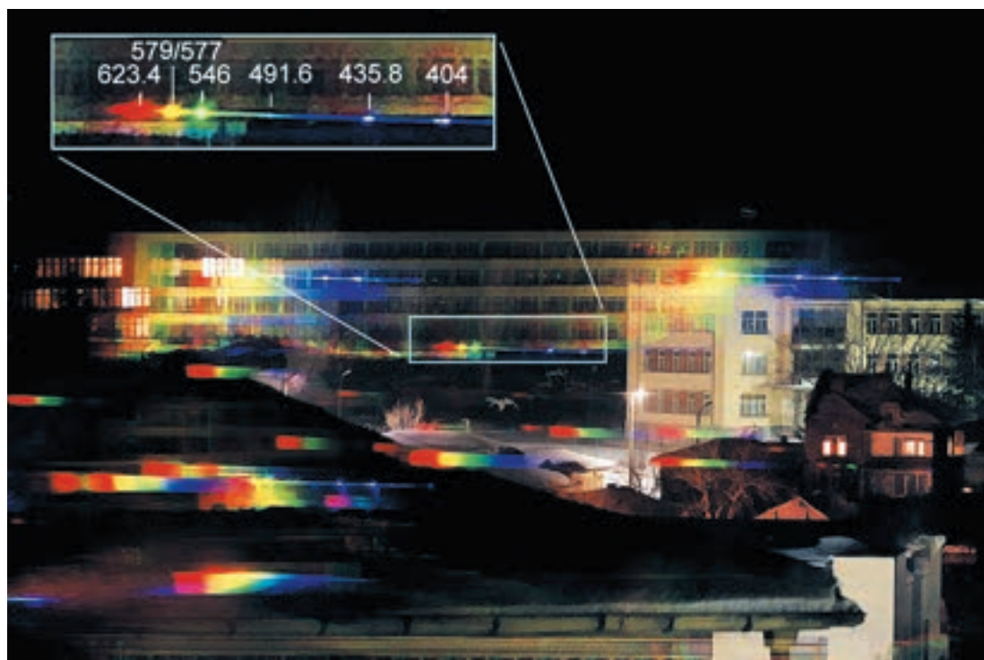
Спектри на нощни градски светлини, заснети с обективна призма, закриваща част от отвора на фотографския обектив. Указани са дължините в нанометри на по-ярките линии в спектъра на живачен уличен осветител (такива вече рядко са в употреба). Снимка: авторът
