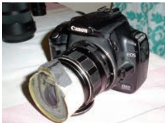
Фотоапарат с монтирана триъгълна призма пред обектива
