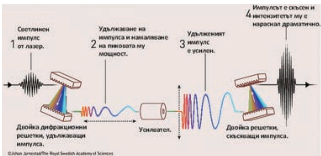
Схемата на действие „разшири, усили, скъси“ при фемтосекунден лазер
