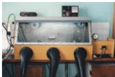
Сензор и електронно устройство за контрол на влага и кислород (ляво) и бокс с аргонска атмосфера и автоматичен контрол на влагата и кислорода (дясно)
