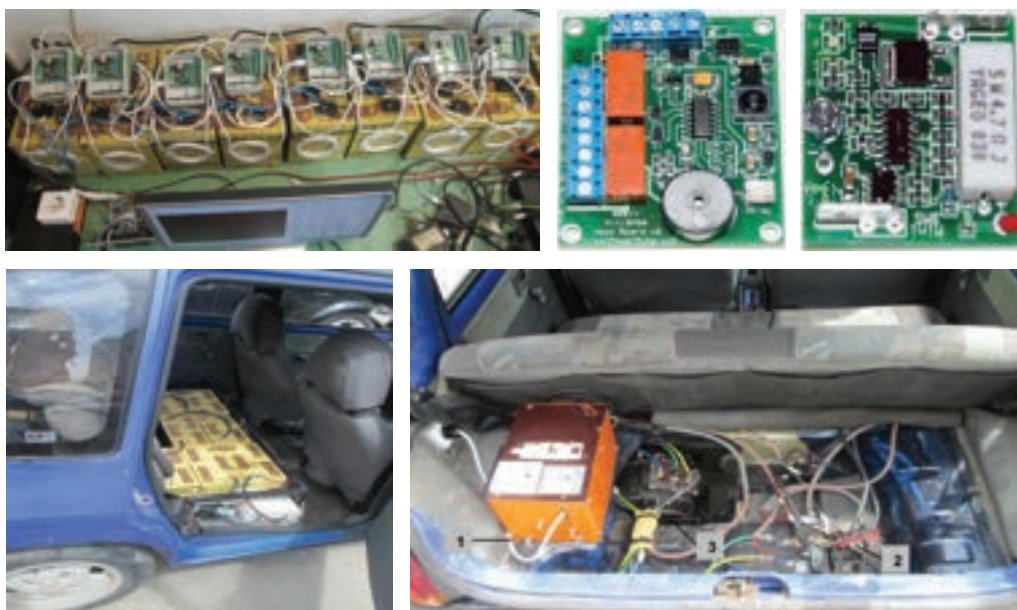
Li-ion батерия от 32 клетки с електронни контролери, електронен блок за управление на батерията, разположение на ел. двигателя, зарядното устройство и батерията в тестовия автомобил
