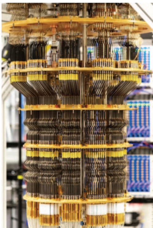
Впечатляващата охлаждателна система на квантовия процесор Willow. Да припомним, че свойството на свръхпроводимост е оперативно само при температури от няколко стотни от градуса над абсолютната нула Кредит: https://blog.google/
